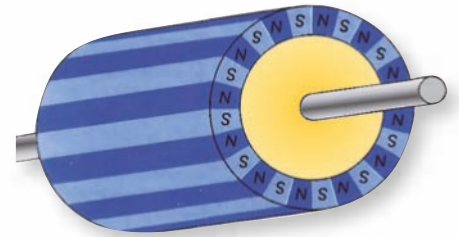
Figura 8: struttura magnetica di un rotore liscio per motore passo-passo a magneti permanenti (numero di coppie polari N_d=12 passo angolare = 7,5°).
